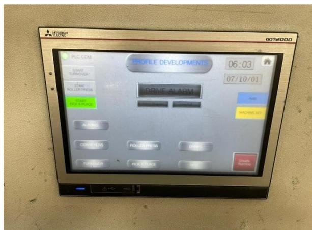
**Immagine 3:** Un HMI widescreen GT2510 intuitivo e facile da usare massimizza la visibilità e l'accessibilità del processo per monitorare e reagire in caso di anomalie.
